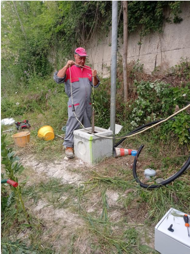
Figura 10: Fissaggio dell'ancora alla catena
