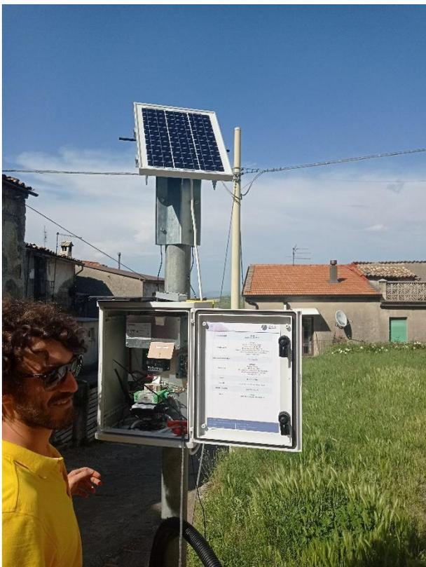
*Figura 22: Cablaggio dei sensori alla centralina*
