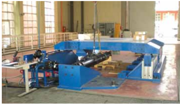
Una delle attrezzature realizzate con il progetto Pon Sila: la tavola vibrante per la simulazione dei terremoti
