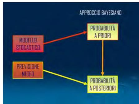
**Figura 24.** L'uso combinato di un previsore stocastico, tipo PRAISE, in grado di fornire una stima della funzione di densità di probabilità *a priori* della pioggia futura, e di un previsore meteo consente di ottenere, attraverso un'opportuna funzione di verosimiglianza, la stima della funzione di densità *a posteriori*, e di tener conto in modo integrato di entrambe le informazioni
