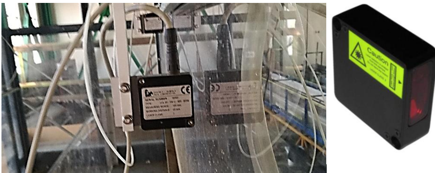
Figura 17: Sensore laser installato (modello LCL45/100 U-485 BI5M).
