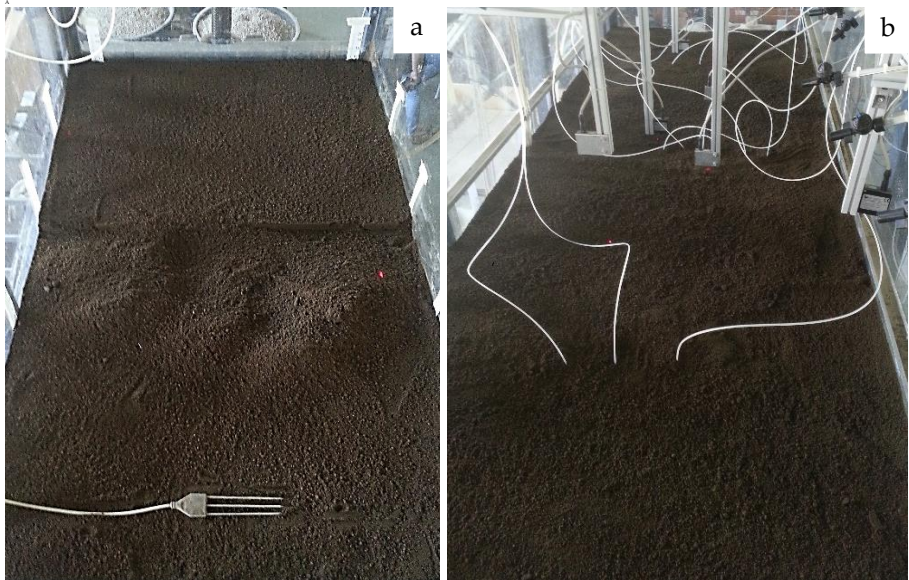
Figura 37: a) ricostruzione del deposito per strato con posa della sonda TDR. b) installazione delle capsule porose dei tensiometri.
