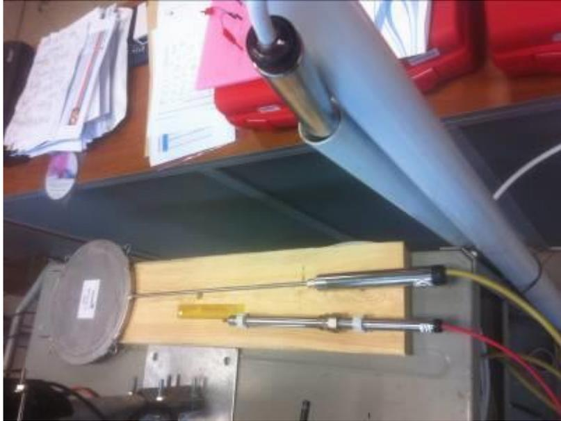
*Sensori di pressione totale, estensimetrico e piezometro (in alto)*
