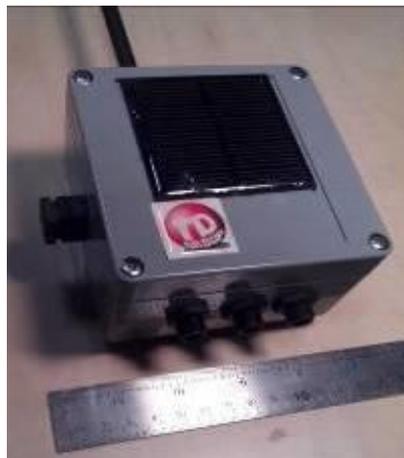
*Nodo sensore e Sink preparati per l'installazione della rete di monitoraggio*
