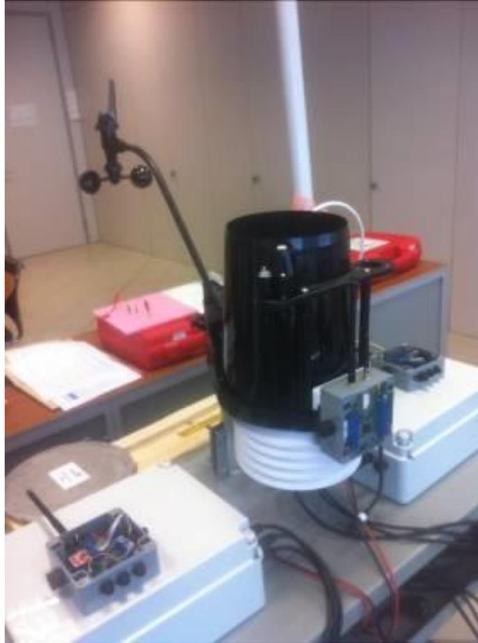
*A sx scatola di deviazione per il cluster di sensori idrogeologici, al centro stazione meteo con Sink e a dx scatola di deviazione per il cluster di sensori per Pozzi*
