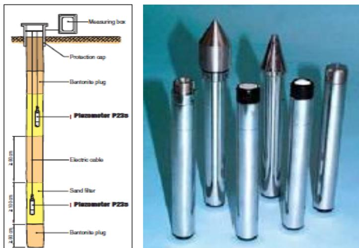
Figura 5. Piezometro a barra e celle di pressione, esempio di sensori
