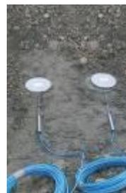
Figura 3. Estensimetri a barra e celle di pressione, esempio di sensori ed installazione in campo
