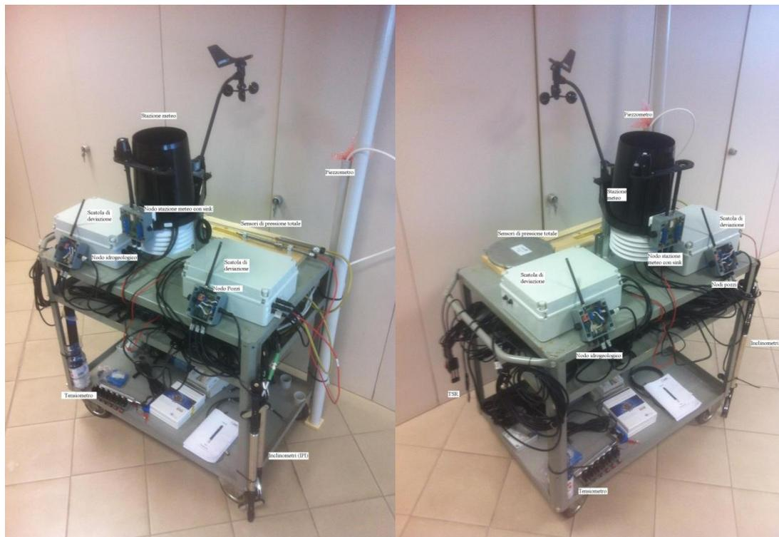
*Banco prova realizzato per la fase di integrazione e test: Le foto rappresentano il banco di prova costruito durante la fase di integrazione e test per la verifica funzionale dei nodi della rete di trasmissione. Il banco di prova ha n.3 nodi (idrogeologico, pozzi, meteo con sink), n.1 gateway, n.2 scatole di deviazione, più un insieme di sensori (sensori di pressione totale, stazione meteo, sensori TSR, Tensiometro, Inclinometri –IPI, Piezometro)*
