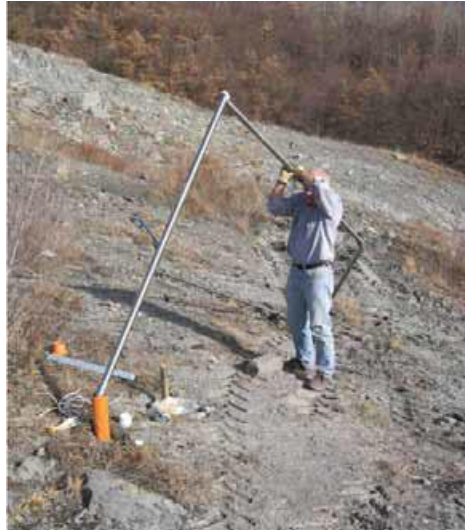
Figura 55. Immagine che mostra un ago durante l'inserimento nel terreno.
