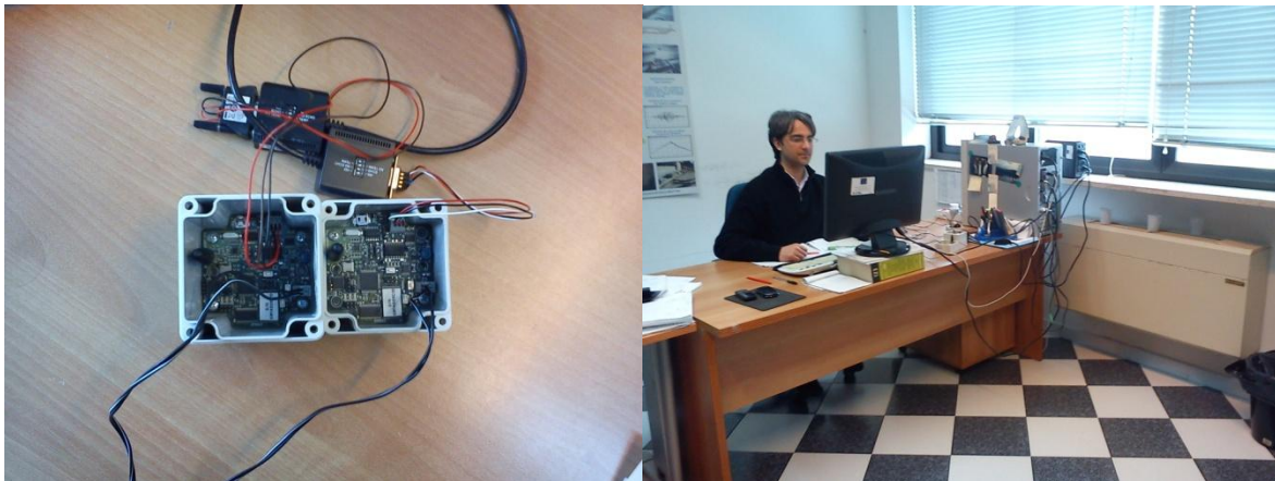
Figura 2. Unità SMAMID master e slave impiegate nei test di comunicazione wireless (sx); postazione sperimentale (dx)
