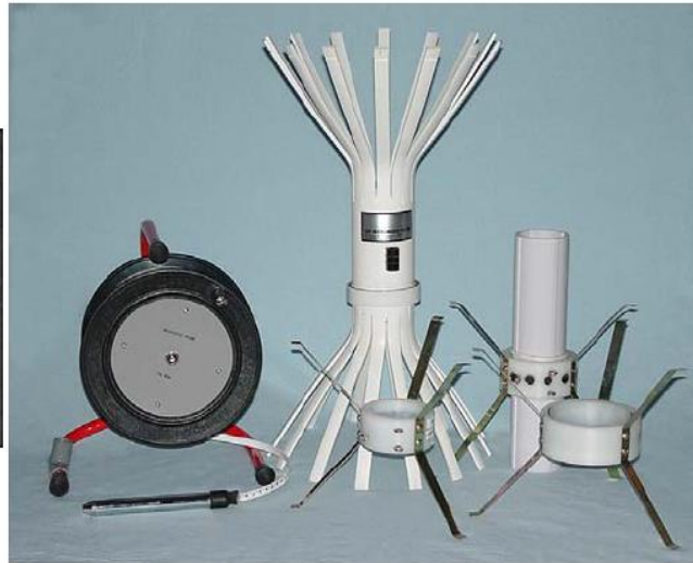
Figura 25. Sonda e anelli impiegati in un assestimetro a sonda
