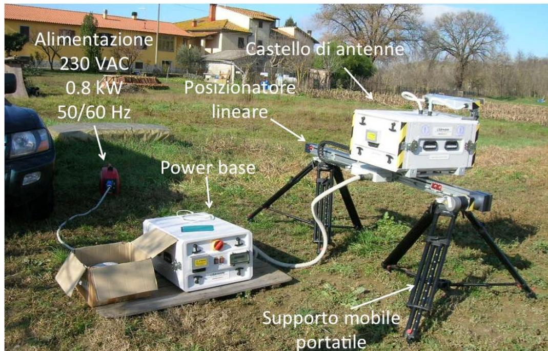
Figura 76. Foto del sistema GB-InSAR impiegato durante il field test in Valdarno.
