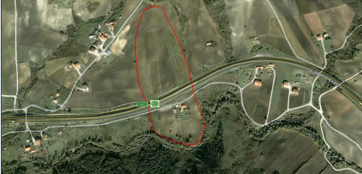
*Figura 27. Dissesto posto al km 97.4 della A16. La sede stradale attraversa il corpo di frana nella sua porzione medio-inferiore.*
