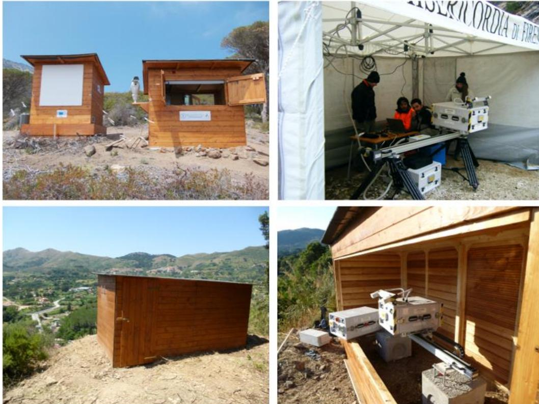
*Figura 75. Esempi di strutture temporanee di protezione dello strumento in caso di monitoraggi di lungo periodo.*
