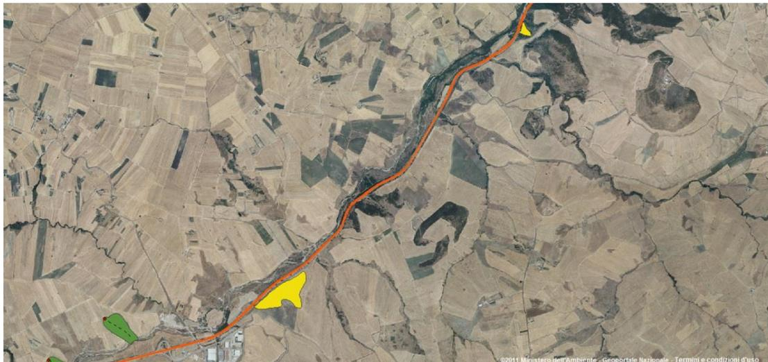
*Figura 10. Dettaglio delle frane nei pressi dello svincolo di Lacedonia (visibile all'estrema sinistra). Le due frane indicate come scivolamenti (in giallo) sono state aggiunte sulla base degli studi condotti da Autostrade per l'Italia. La legenda è mostrata in Figura 8.*
