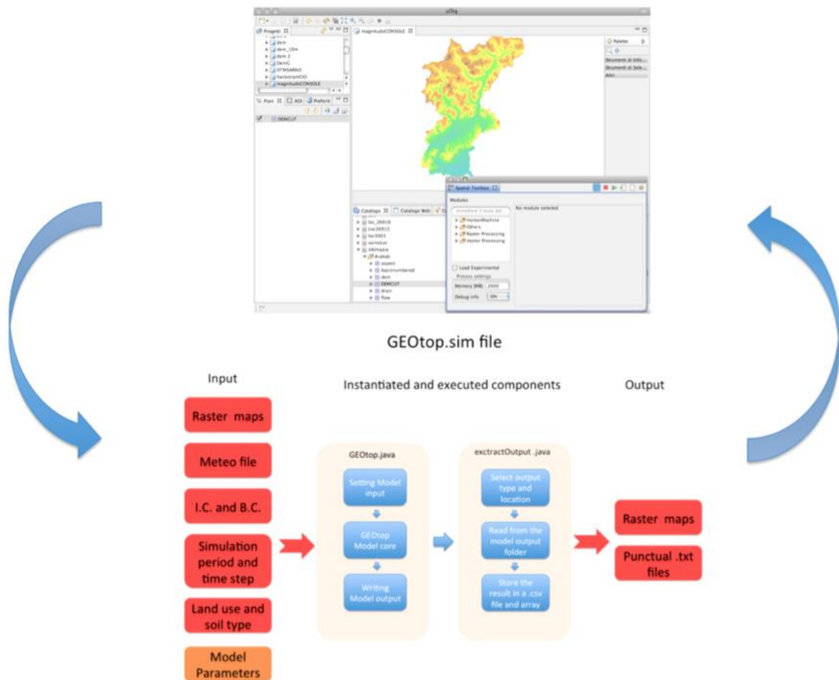
Figura 3: Interazione del modello con il GIS JGrass usando OMS3 sim file
