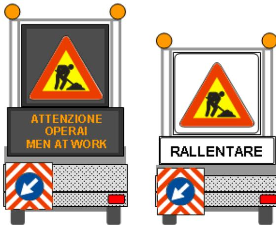
*Figura 3 – Esempio di PMV su Carrello mobile per situazioni di Emergenza da collocare in prossimità alle situazioni di pericolo o ai punti di deviazione*
