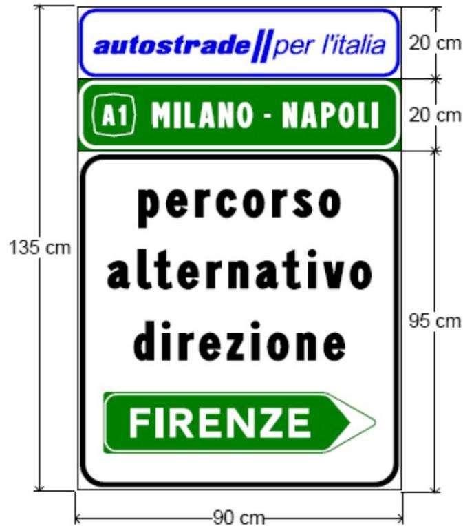
*Figura 4 – Esempio di Progettazione Pannello temporaneo da collocarsi in prossimità dei punti di svolta da parte del personale operativo dei gestori stradali*
