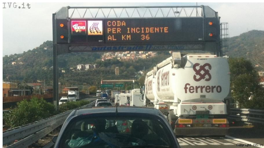
*Figura 2 – Esempio di Pannello a Messaggio Variabile per la segnalazione di situazione di traffico*
