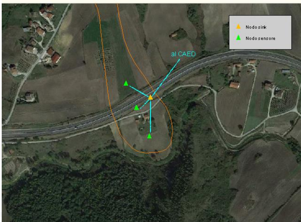
A16, km 97+450: Rete di trasmissione
