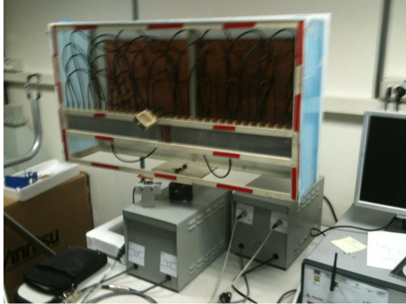
SDRadar in banda L in fase di realizzazione
