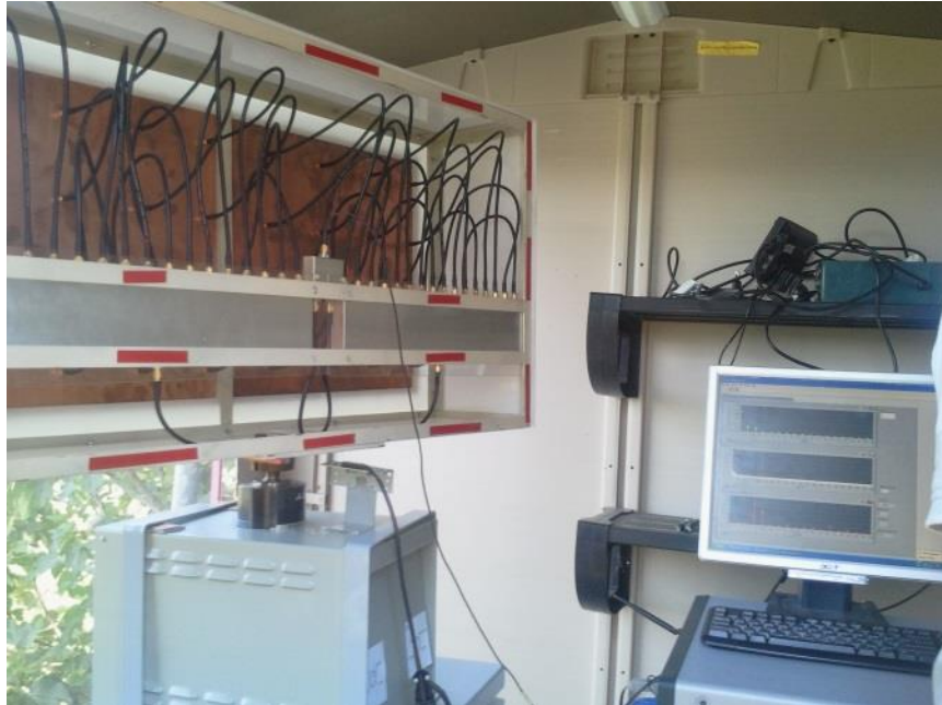
A3, UGM 1 - Connessione dell'SDRadar al sistema di acquisizione e trasferimento dati
