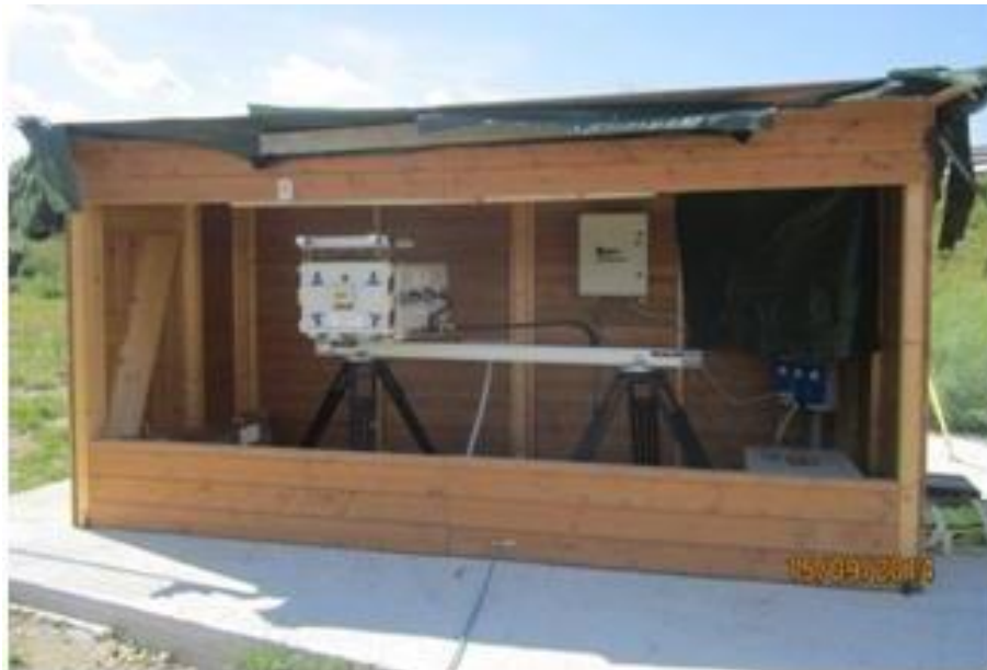
A16, UGM 1: centro di acquisizione e trasmissione dati Sistema MEMS (STRAGO S.p.A.)
