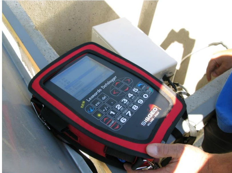
A3, UGM 1: scatola di derivazione e verifica dei dati acquisiti mediante centralina portatile
