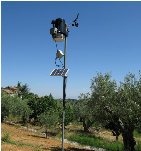
A3, UGM 2: stazione meteorologica e nodo sink
