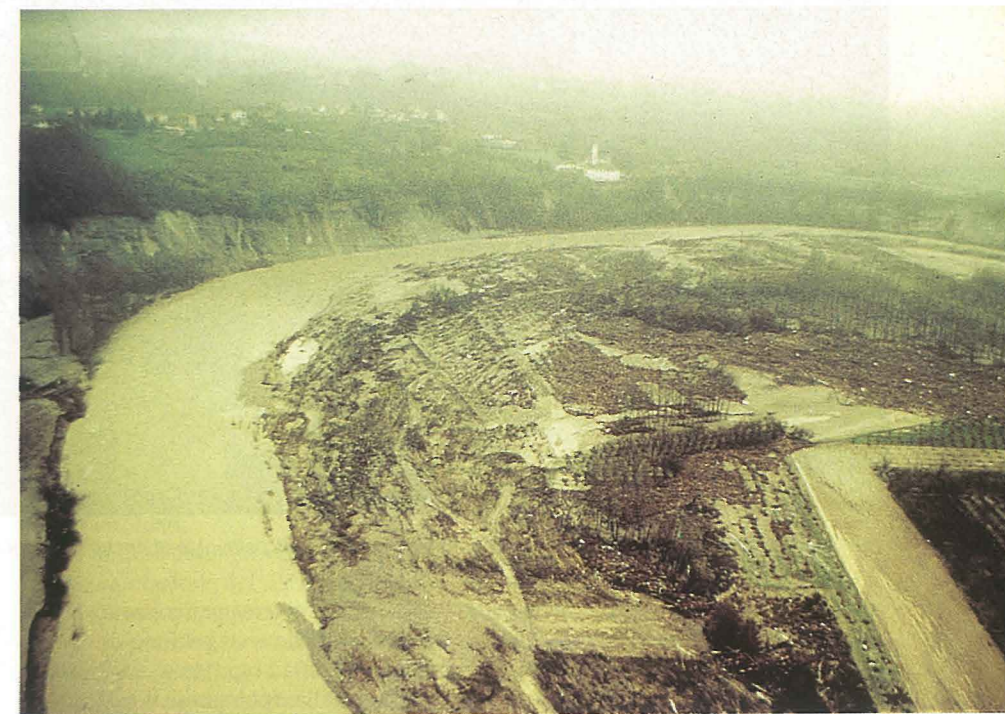
Valle del Tanaro presso la Fraz. Naviente di Farigliano. Sezione di deflusso ampliata a tutto il fondovalle, con depositi di tronchi arborei fluitati (soprattutto pioppi) per vari metri di spessore. (Archivio IRPI-Torino)
